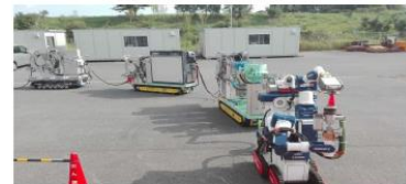
図2 上部階用除染装置
