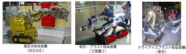
図2 平成24年度に製作した除染装置
