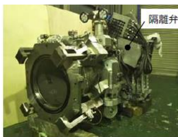
X-6ベネ接続構造(隔離弁付連結管)
