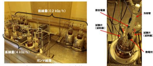
図2 照射環境における試験状況
