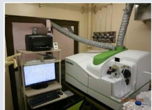
ICP-MSを用いた 90 Sr分析装置
