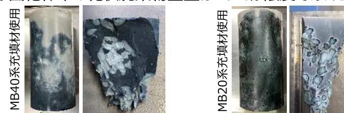
小規模充填固化体(円筒型)の側面外観と破壊後の内部破断面
