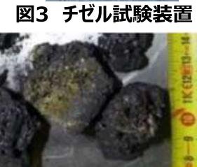
図4 アルゴン雰囲気で製造したRPV模擬燃料デブリ
