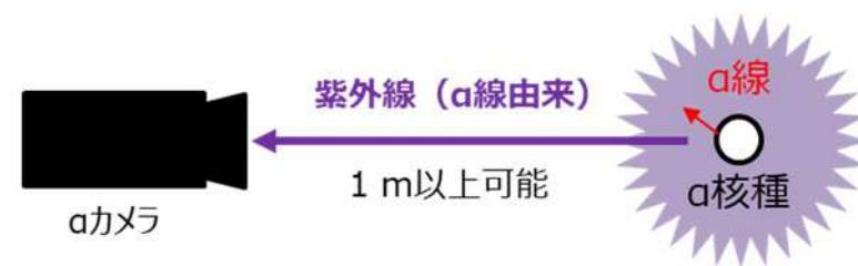
α線が空気中を通過する際に窒素分子を励起することによって発生する紫外線を検出
