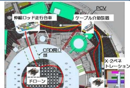
図2 ドローンによるアクセスイメージ
