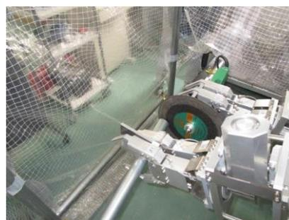
グラインダーによる鋼材の切断状況
