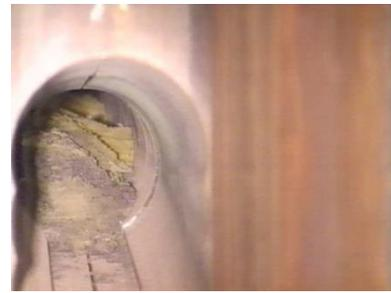
写真 C 燃料デブリの例 (ウィンズケール)
